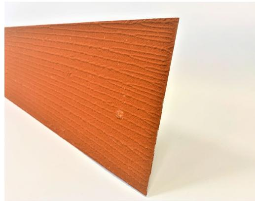
Um sicher abzudichten genügt eine Betoneinbindung von nur 3 cm. Das EASYflex FB aktiv ist wasserreaktiv und dichtet somit Arbeits- und Sollrissfugen aktiv durch einen natürlichen betontechnologischen Prozess ab. Wasserdrücke bis einschließlich 5,0 bar = 50 mWS können sicher abgedichtet werden!
