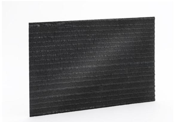
Um sicher abzudichten genügt eine Betoneinbindung von nur 3 cm. Das CEMflex® VB ist wasserreaktiv und dichtet somit Arbeits- und Sollrissfugen aktiv durch einen natürlichen betontechnologischen Prozess ab. Wasserdrücke bis einschließlich 8 bar = 80 mWS können sicher abgedichtet werden!
